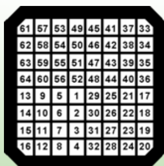
Расположение электродов (вид с внутренней стороны)
