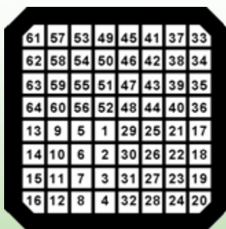
Расположение электродов (вид с внутренней стороны)
